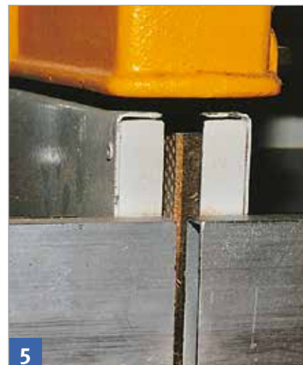
Schmaler Schlitz für Sägeblattdurchtritt
